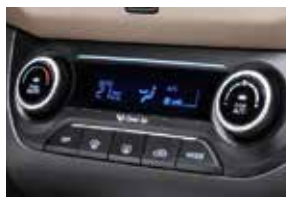
Aire acondicionado con climatizador
